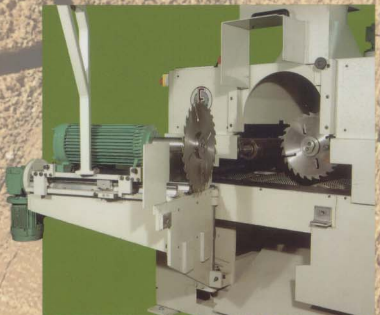
Máquina combinada: múltiple-canteador. Machine combiné: multiple-deligneur. Combinated machine: multiple rip saw-edger.
