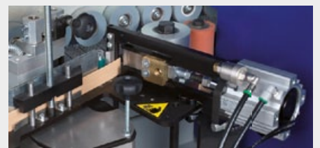
6 Schlagschere - Pneumatische Vorkappung
