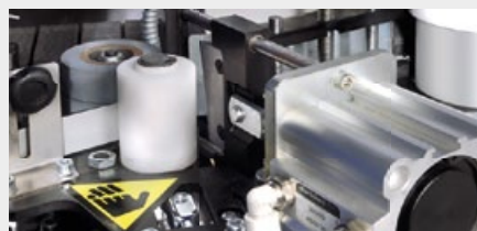
5 Schlagschere - Pneumatische Vorkappung
