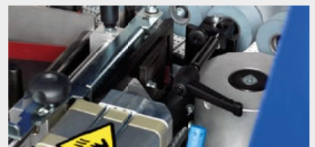
6 Schlagschere - Pneumatische Vorkappung
