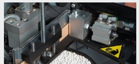
3 Kantenzuführung für Rollen- und Streifenmaterialien
