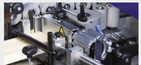
3 Kantenzuführung für Rollen- und Streifenmaterialien (Abbildung inkl. Streifenmagazin)
