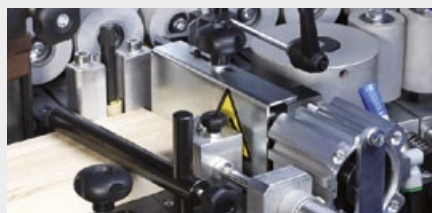
5 Schlagschere - Pneumatische Vorkappung (Abbildung inkl. Streifenmagazin)
