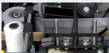
2 Kantenzuführung für Rollen- und Streifenmaterialien
