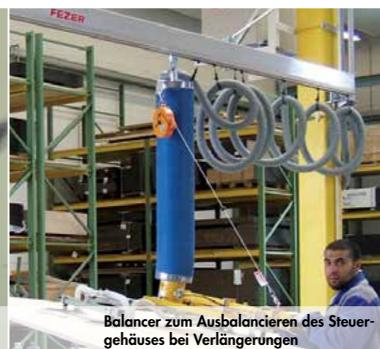
Balancer zum Ausbalancieren des Steuergehäuses bei Verlängerungen
