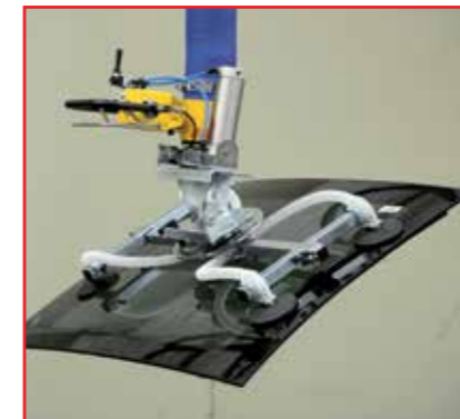
pneumatische Schwenkvorrichtung zum Schwenken von Werkstücken um 90°
