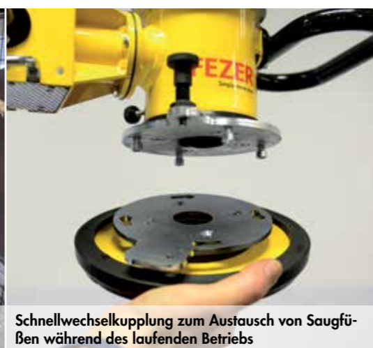
Schnellwechselkupplung zum Austausch von Saugfüßen während des laufenden Betriebs
