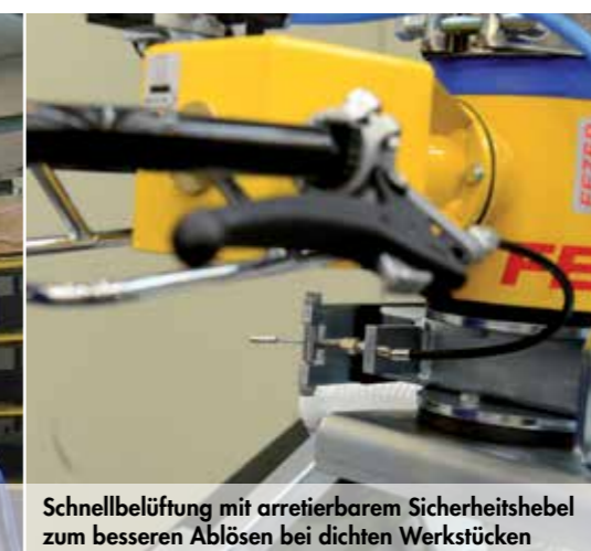
Schnellbelüftung mit arretierbarem Sicherheitshebel zum besseren Ablösen bei dichten Werkstücken
