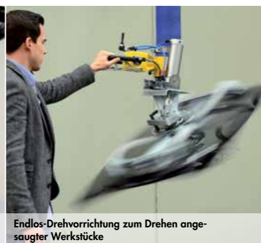
Endlos-Drehvorrichtung zum Drehen angesaugter Werkstücke
