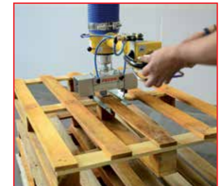
Palettengreifer mit pneumatisch verstellbaren Untergreifern
