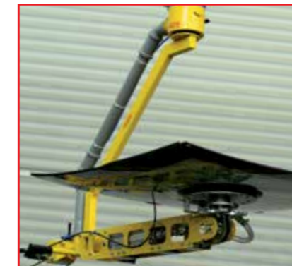
pneumatische Wendevorrichtung zum Wenden von Werkstücken um 180°
