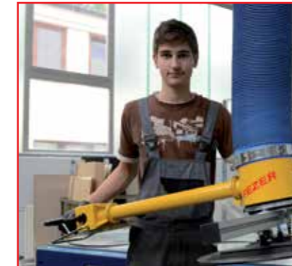
Verlängerung für Steuergehäuse bei großflächigen Werkstücken
