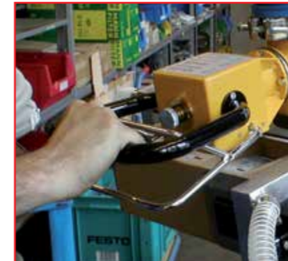
Steuergehäuse mit Kipphebel für intuitive und einfache Bedienung
