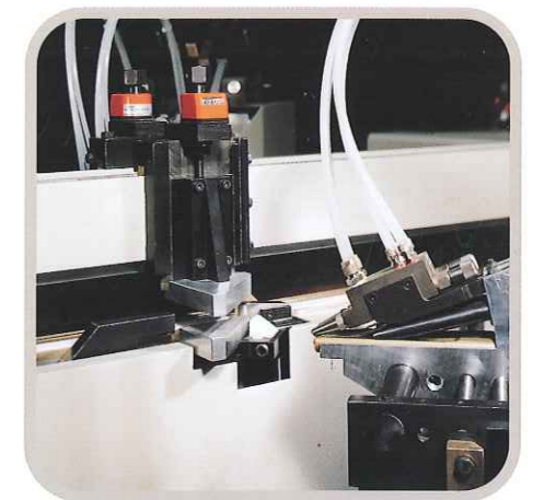
Klemmeinrichtung für Werkstücke. Dies ist bei allen Profiler-, Bohr-, Leimeingabe- und Dübeleingabeggregat möglich.
