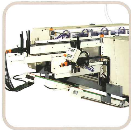
Absetzstation mit Rückführband, eingebaut in den Maschinenständer. Damit werden die fertigen Werkstücke zum Bediener zurück transportiert, dies erfordert keinen weiteren Maschinenbediener am Maschinenauslauf.
