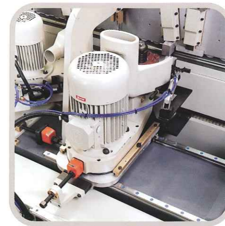
Profilierspindel mit Konterprofil und Druckbalken um perfekte Oberfläche und Genauigkeit zu gewährleisten.
