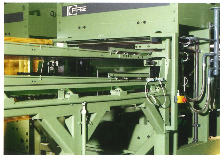
Abrolltablets sorgen für eine schnelle und störungsfreie Pressenbeladung.
