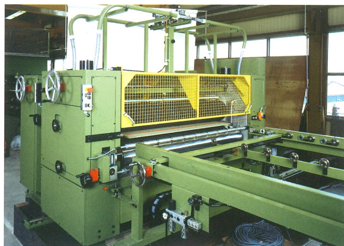
Bürstenreinigung der Platten und Leimauftragmaschine mit automatischer Leimzufuhr für PVAc- oder Harnstoff-Formaldehydleime. Zur Reinigung wird die Maschine seitlich herausgefahren.
