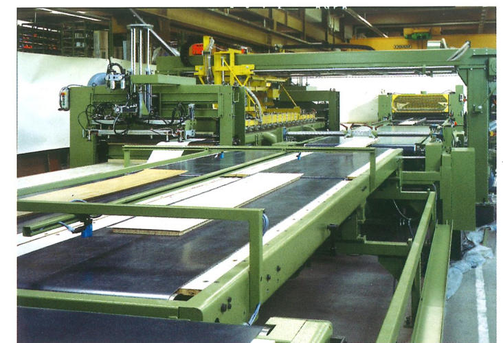
Versetzstation zur zweiseitigen Belegung der Presse und zum Aufreihen mehrerer Werkstücke hintereinander.
