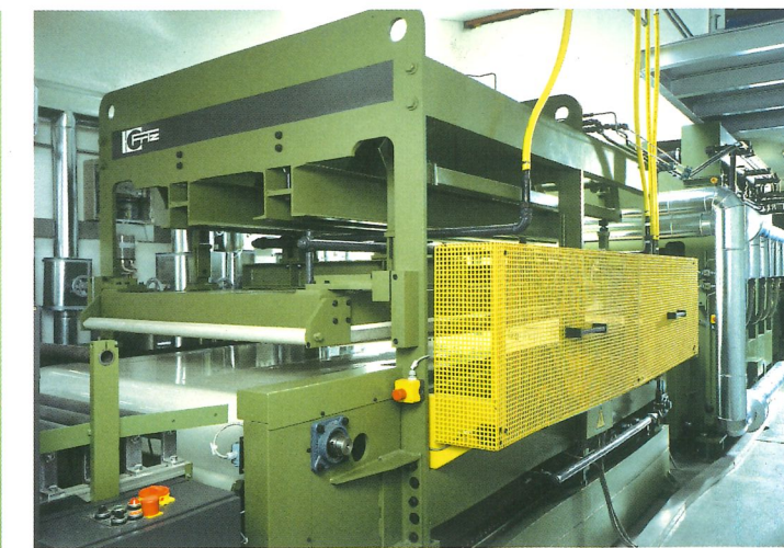
Nachgeschaltete Kühlpresse in der Laminatproduktion.
