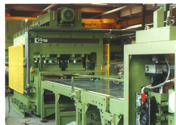
Pressenbelegeband mit Beschleunigungsband hinter dem Kaschierblock, um kontinuierliches Kaschieren auch während dem Preßchargenwechsel zu ermöglichen.
