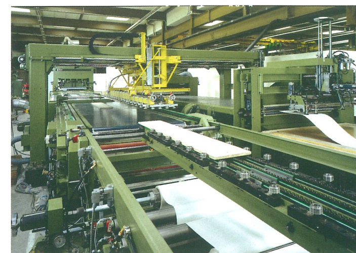
Automatische Ausricht- und Legestation für unteres und oberes Laminat und Mittellagenübergabe. Oberes und unteres Laminat werden der Ausrichtstation mittels zwei gegenüberliegenden Bürstenmaschinen zugeführt.
