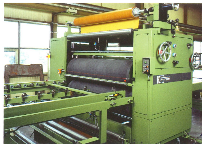
Kaschierblock zum Kaltkaschieren auch von Dünnpapieren. Doppelabwickelstationen oben und unten mit automatischer Folienanstückelung sind möglich.
