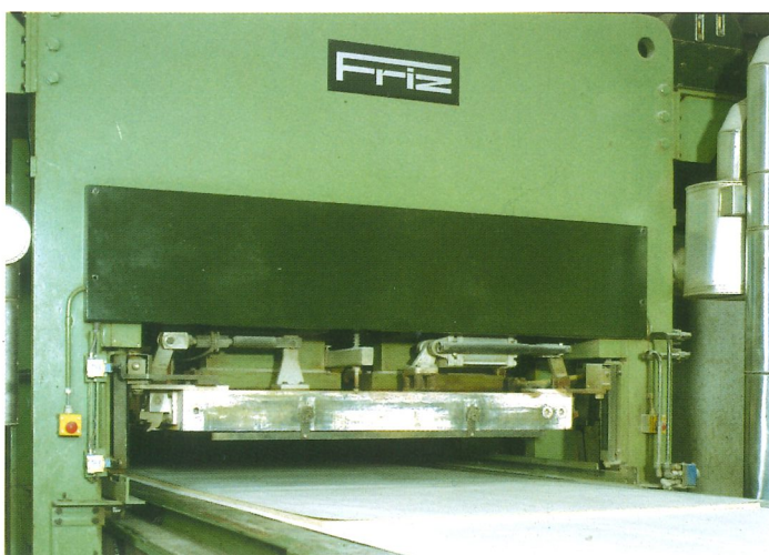
Pressenbeschickung mit Abrolltablett. Dieses System gewährleistet kürzeste Liegezeiten vor dem Druckaufbau.
