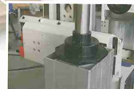
Установка инструмента осуществляется непосредственно на вал прецизионного электродвигателя без дополнительных передаточных механизмов. Direktantriebmotor mit Spindeldurchmesser 50 mm. High precision direct driven motor 50mm ø spindle.
