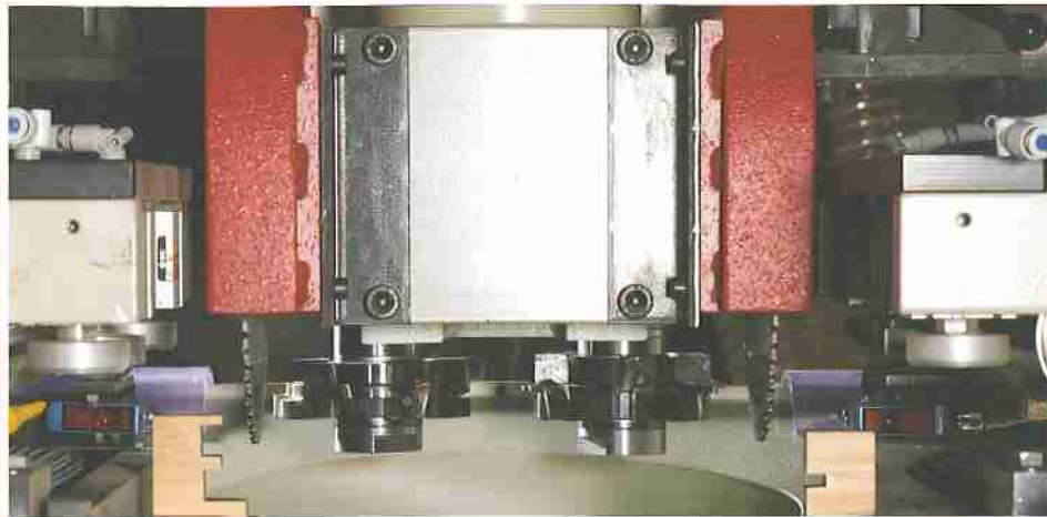
Отрезной/профилирующий агрегат, оснащенный упорными блоками для предотвращения сколов. Detailaufnahme des Abläng- und Fräseaggregates mit Konterklotz gegen Splitterung. Detail of the cutting/profiling aggregate provided with back-up blocks.
