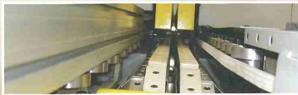
Автоматическая система центрирования заготовки с боковой регулируемой дилейкой и ленточным приводным транспортером с противоположной стороны. Automatisches Zentrierungssystem am Einlauf der Längsbearbeitungsmaschine mit einstellbarem Seitentranschlang und gegenüberliegendem angetriebenen Druckriemen. Automatic infeed centering system with lateral adjustable fence and motorized opposite belt.
