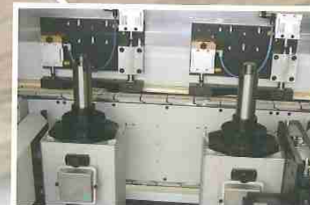
Подвижные и не подвижные фрезерные агрегаты с устройством прижима заготовок сверху. Detailaufnahme Profiler- und Tauchaggregat mit pneumatischen oberen Druckriemen. Jump and fixed profiling units with pneumatic top pressure device.
