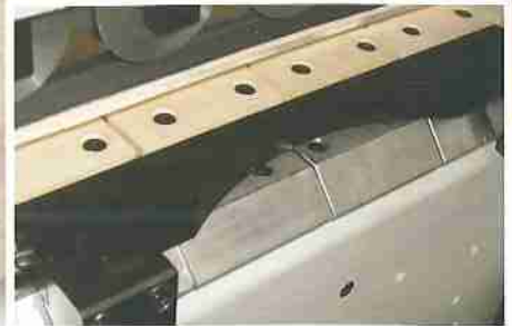
Направляющая поверхность конвейера с форсунками образующая воздушную подушку для уменьшения трения между лентой транспортера и направляющей поверхностью. Untere Bezugsschiene mit Luftpolster der Bearbeitungsaggregate. Bottom air cushioned supporting plate.
