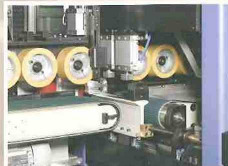
Верхний и боковой прижимные элементы, упорный блок для предотвращения сколов и передний датчик положения.
