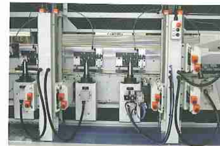
Конфигурация 5+5 шпинделей для станка для поперечной обработки заготовок. Ausrüstung der 5+5 Spindel-Querbearbeitungsmaschine. 5 + 5 spindle configuration for crosswise processing machine.
