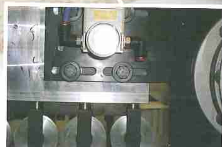
Приводной ленточный конвейер для прижима заготовки сверху. Obere pneumatische Druckriemen durch Motor angetrieben. Pneumatic motorized top pressure belt.
