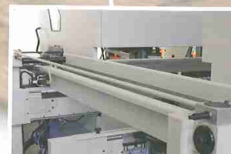
Накопитель для станка для поперечной обработки заготовок. Automatisches Magazin am Einlauf der Querbearbeitungsmaschine. Hopper feeder for cross wise profiling machine.
