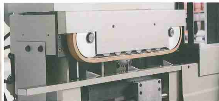
Элементы системы подачи и прижима заготовок. Detailaufnahme des Vorschub- und Drucksystems. Detail of the feed system and the hold-down system.
