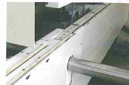
Выходной приводной конвейер для станка для поперечной обработки заготовок. Motorisierte Druckriemen am Auslauf der Querbearbeitungsmaschine. Outfeed crosswise processing motorized belt.
