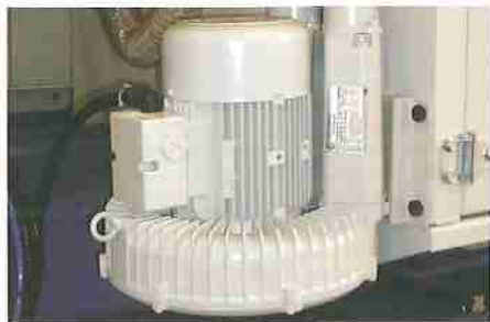
Цепной конвейер, оснащенный пневматической системой натяжения. Unterdrucksetzungspumpe der Vorschubskette. Feed chain assembly pressurizing pump.
