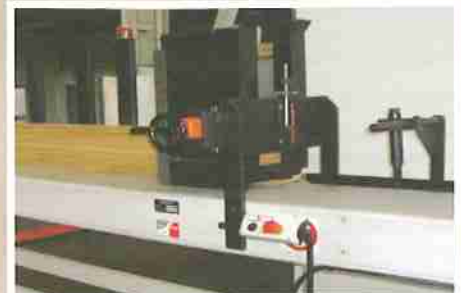
Накопитель для станка для продольной обработки заготовок. Automatisches Magazin am Einlauf der Längsbearbeitungsmaschine. Hopper feeder for lengthwise profiling machine.
