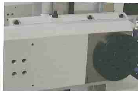
Подвижная чугунная опора для установки рабочих агрегатов. Detailaufnahme der gusseisernen Gleitsschritten für die Bearbeitungseinheiten. Details of cast-iron working units mounting slide.
