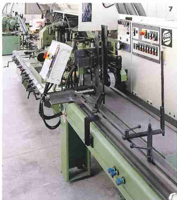
7-8 - Vista della FN/6 applicata alla scorniatrice. View of the FN-6 applied to the moulder. Beschickung FN-6 in der Aufstellung am Kehlautomaten. Vue de la FN/6 appliquée à la moulurière. Vista de la FN/6 aplicada a la moldurera.
