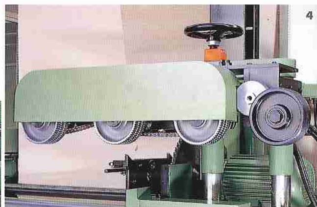
4 - Esecuzione speciale del sistema di inserimento pezzi corti in scorniciatrici cabinate. Special execution for feeding short pieces in moulder with sound enclosure. Spezialausführung zur Beschickung kurzer Teile in Kehlautomaten mit Lärmschutzkabine. Exécution spéciale du système d'insertion pièces courtes dans des moulurières munies de cabines d'insonorisation. Ejecución especial del sistema de alimentación de piezas cortas en moldurera equipada con cabina de insonorización.
