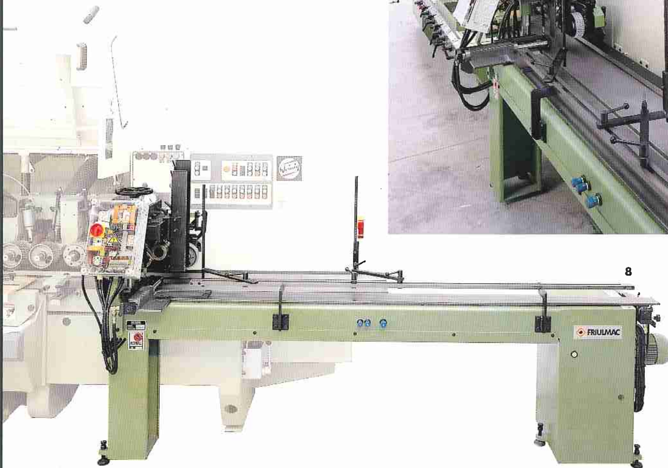
7-8 - Vista della FN/6 applicata alla scorniatrice. View of the FN-6 applied to the moulder. Beschickung FN-6 in der Aufstellung am Kehlautomaten. Vue de la FN/6 appliquée à la moulurière. Vista de la FN/6 aplicada a la moldurera.
