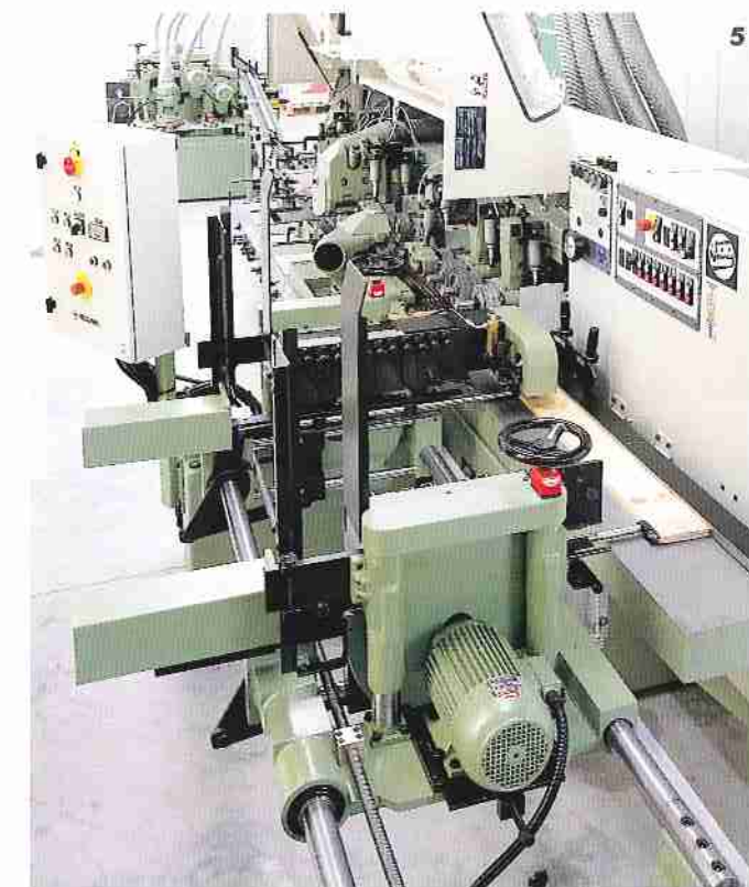
5-6 - Vista della FN/3 applicata alla scorniciatrice. View of the FN-3 applied to the moulder. Maschine FN-3 am Kehlautomaten. Vue de la FN/3 appliquée à la moulurière. Vista de la FN/3 aplicada a la moldurera.
