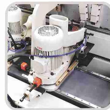
Profilierspindel mit Konterprofil und Druckbaiken um perfekte Oberfläche und Genauigkeit zu gewährleisten.
