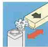
Profiliereinheit, J-34, Riementrieb
