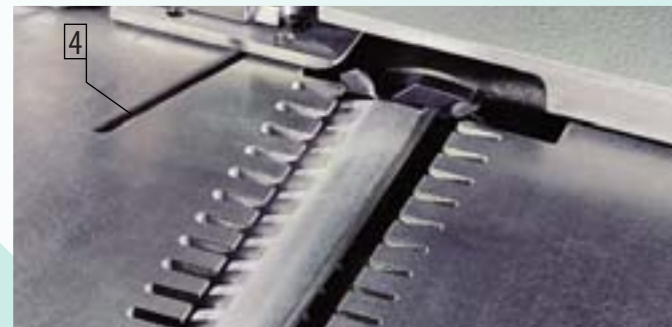
Rullo prepiaila pneumatico con esclusione ON-OFF su quadro comandi. Pneumatic pre-planer roller with ON-OFF exclusion on control panel. Rodillo pre-cepillo neumático con exclusión ON-OFF en el cuadro de mandos.
