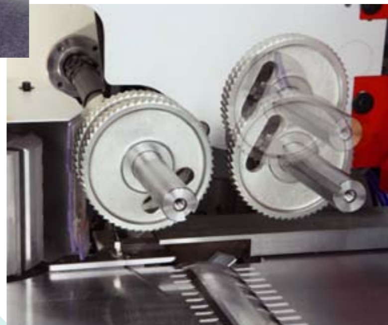
Rullo prepiaila pneumatico con esclusione ON-OFF su quadro comandi. Pneumatic pre-planer roller with ON-OFF exclusion on control panel. Rodillo pre-cepillo neumático con exclusión ON-OFF en el cuadro de mandos.
