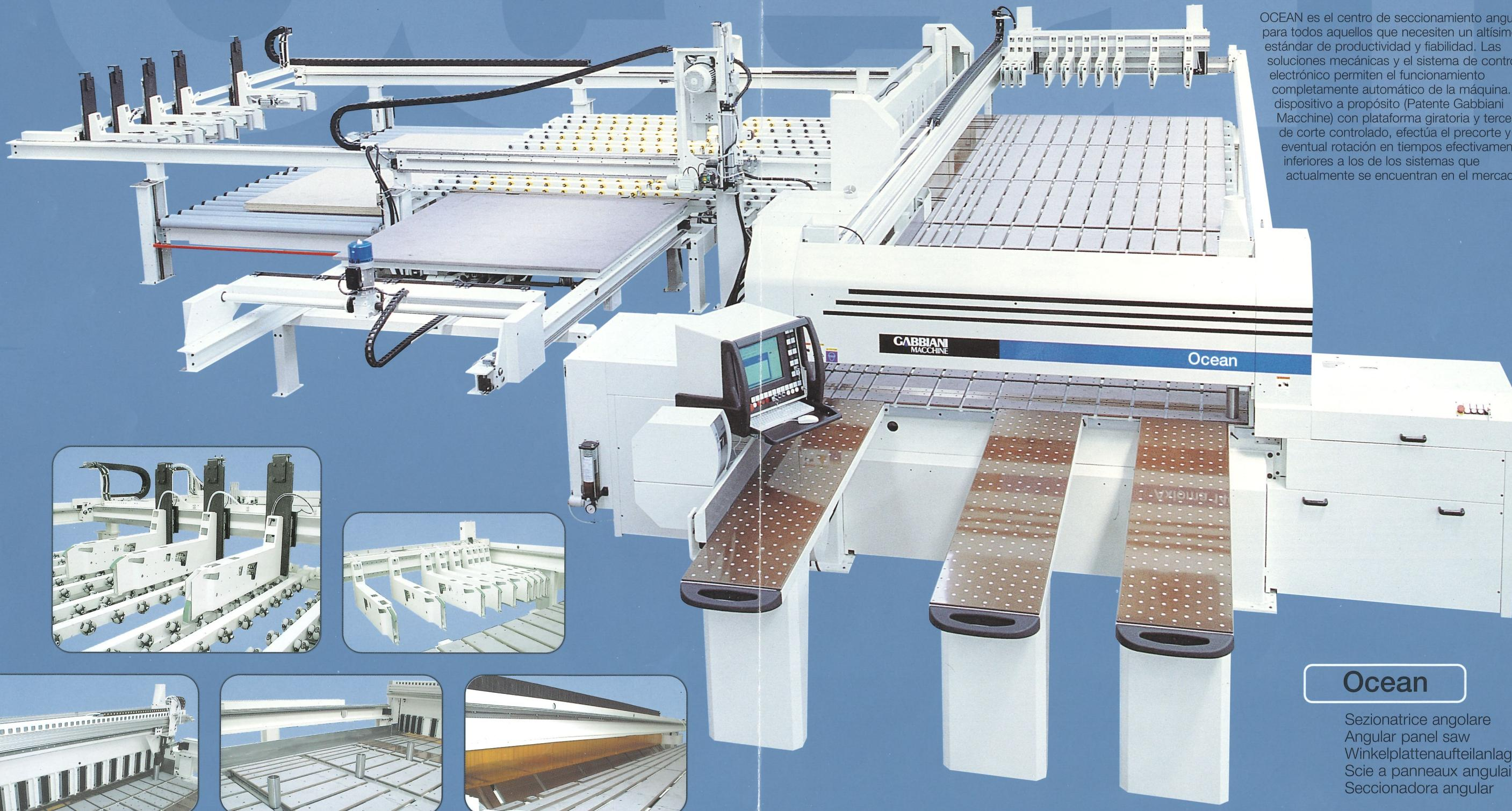
OCEAN è il centro di sezionatura angolare per chi richiede altissimi standard di produttività ed affidabilità. Le soluzioni meccaniche ed il sistema di controllo elettronico consentono il funzionamento completamente automatico della macchina.
