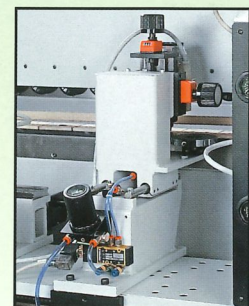
Gruppo stondatore-refilatore bordi soft giunzione 45° Corner rounding unit for softform edges with 45° jointing Grupo redondeador-refilador, cantos softfor- ming unión 45° Abrundaggregat für Softformkanten mit 45° Fügung Groupe d'affleurage-arrondisseur, chants softformés et jonction à 45°
