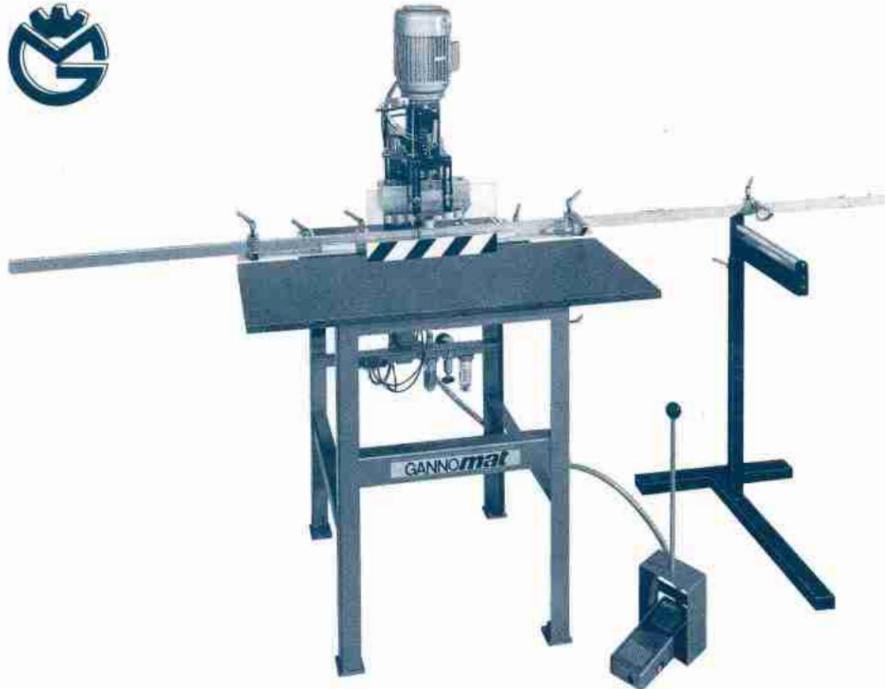
**Reihen- und Beschlägebohrmaschine
