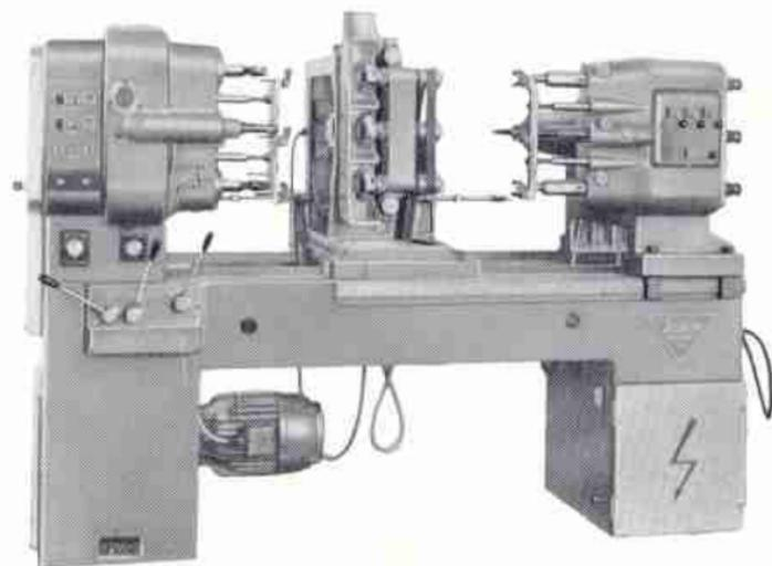
Kopierfräsautomat Modell 90—120. Diese Maschine fertigt gleichzeitig drei asymmetrische Werkstücke nach Modell (z. B. Gewehrkolben oder Möbelbeine) · Die Spindeln haben öhydraulischen Antrieb · Automatische Verlangsamung der Umdrehungsgeschwindigkeit an schwierigen Stellen · Der Arbeitsablauf der Maschine ist vollständig automatisiert
