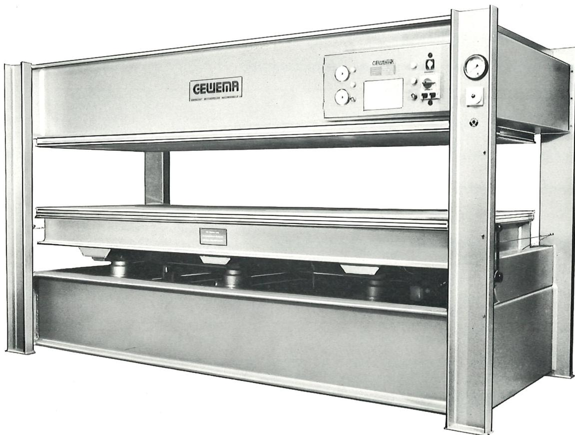
Das Modell P 120 ist eine schwere hydraulische Furnierpresse mit einer Gesamtpreßkraft von **120 000 kg**. Durch die offenen Seiten über die gesamte Plattenlänge von 3000 mm und Plattenbreite von 1300 mm ist die Presse für Betriebe, die Innenausbauarbeiten machen, vorteilhaft und vielseitig einsetzbar.
