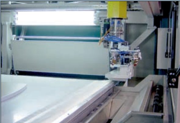
Synthetic conveyor belt and water disposal • Bande en matériel synthétique avec abattage humide • Kunststoffband mit WET-Abdunstsystem • Tapete sintético con sistema de extracción húmedo
