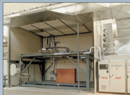
Stack edges finishing • Finition de chantis en catasta • Fertigung von Kanten gestapelter Paneelen • Barnizado de cantos paneles apilados
