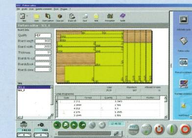
La fonction "editing" du G-57 permet l'introduction des schémas de coupe, avec la machine en marche.
