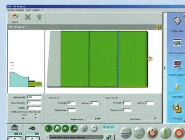
Visualisation graphique du schéma de coupe et des différentes phases de travail en temps réel. Avec cette représentation l'opérateur est guidé pas à pas dans les opérations à exécuter.
