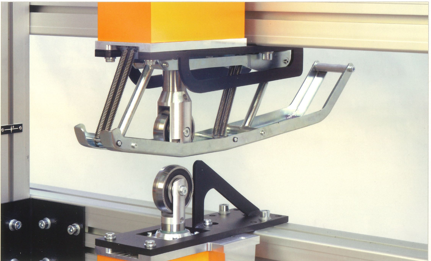
Berührende Messung mit ct-Messrahmen
