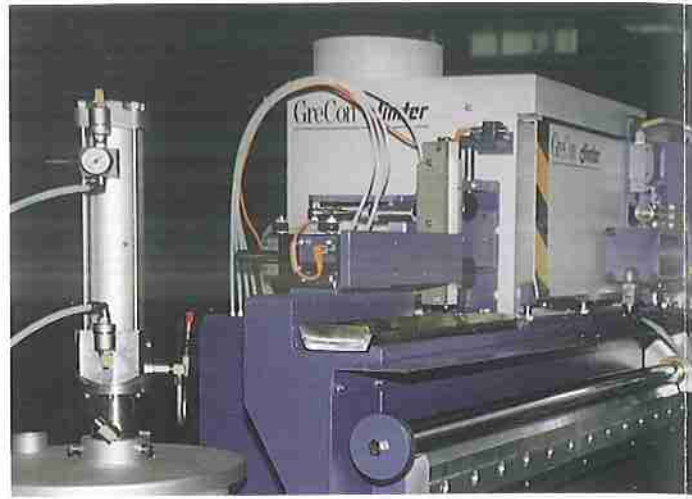
Geschlossenes Leimpumpen-System: FLANKENJET
