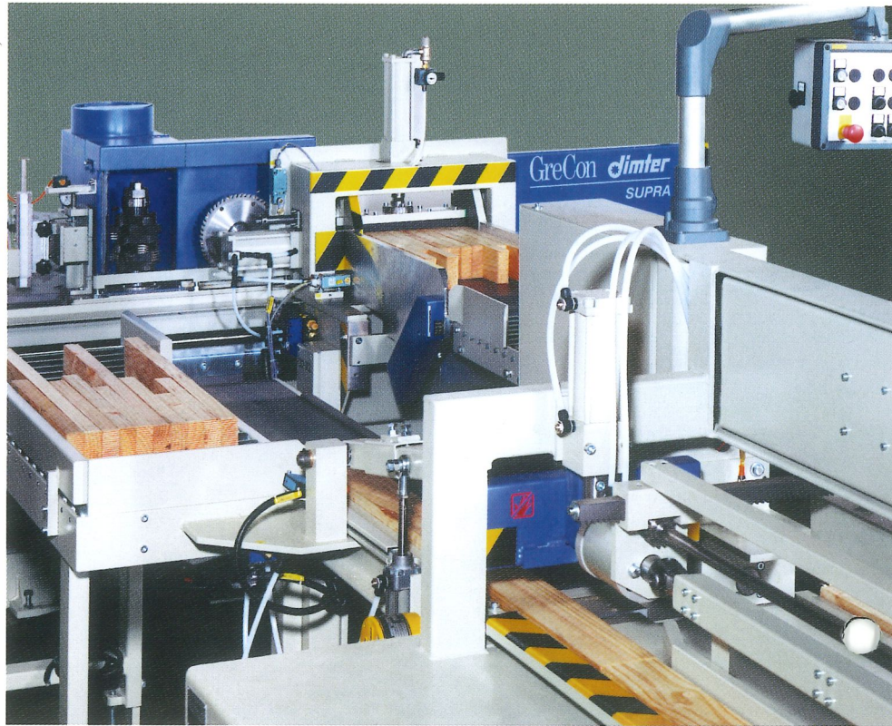
Fräse mit Flankenjet-Leimsystem, Übergabestation mit Einfädelung und Presse
