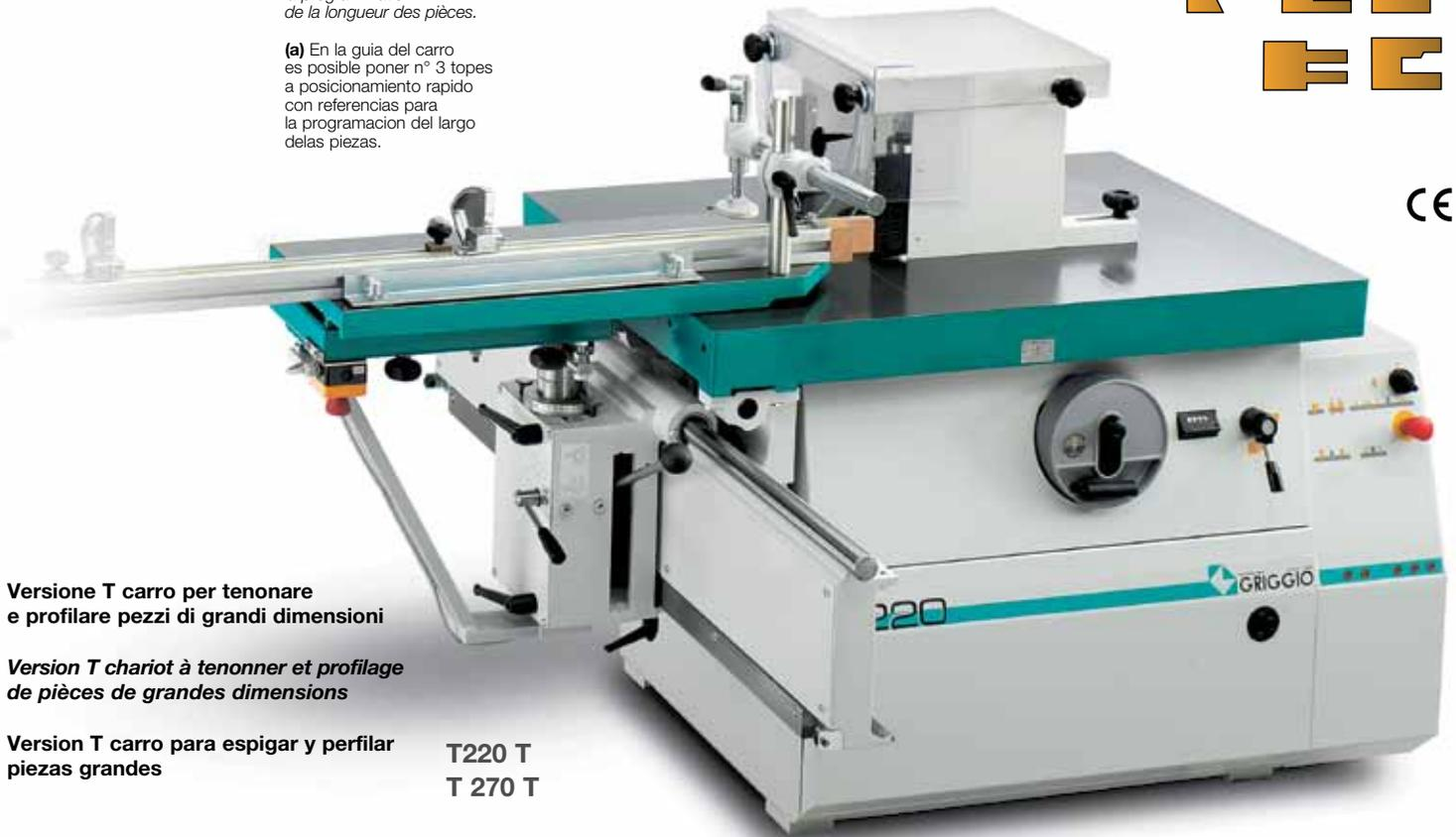
**Versione T** carro per tenonare e profilare pezzi di grandi dimensioni
