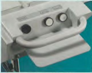
Option Automatic star-delta start on sliding table Stern-Dreieck-Betätigung auf dem Sägeschlitten Запуск звезда-треугольник на подвижной каретке
