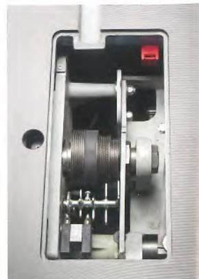
Manual speed change on the table. Handgeschwindigkeitswechsel im Tisch Смена скорости на столе
