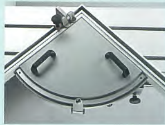
Option Double angular fence – tilted cuts 0°-45° Doppelwinkelschlag - schräge Schnitte 0°-45° Двойной угловой упор для резов под углом 0°-45°
