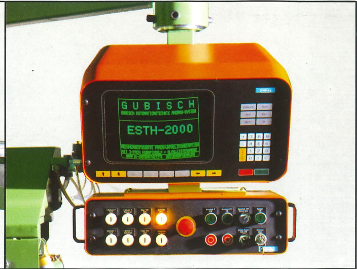
Übersichtliches Steuerpult mit Bildschirmbedienführung. Programmspeicherung für Längs- und Querholzbearbeitung sowie Umfälzbetrieb möglich.
