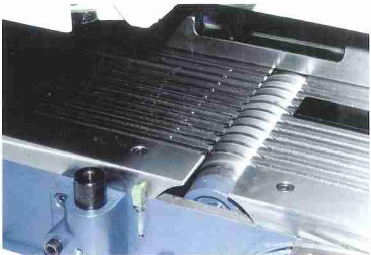
Innerhalb der Maschine durch Kardanwellen angetriebene Tischwalzen – auch beim Einsatz eines Nutentisches !
