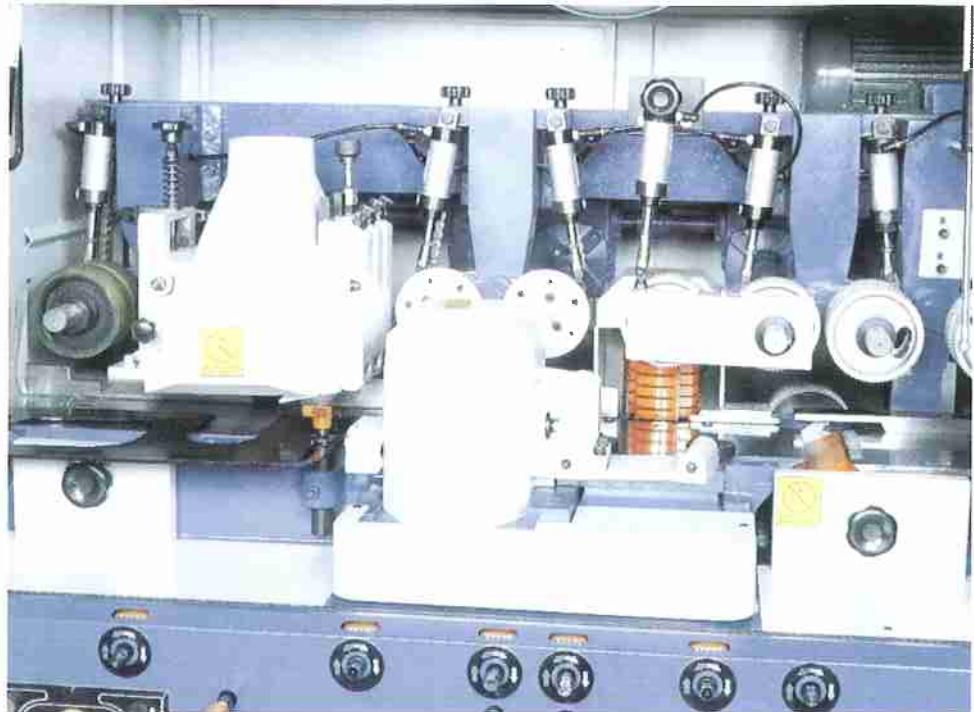
Massives, durchgehendes Vorschubsystem. Total kettenlos. Jede Vorschubwalze hat ein eigenes Getriebe. Pneumatischer Vorschubwalzenantrieb. 100 mm breite Vorschubwalzen (Nicht im Bereich der linken Spindel).
