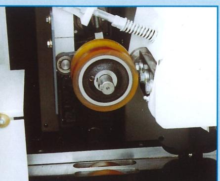
**L**'arbre de toupie gauche est muni d'un déplacement horizontal indépendant par rapport à la ligne des presseurs latéraux, lors d'un changement d'outils, il suffit de régler la position de l'outil en affichant son rayon de base sur le compteur digital mécanique. La table face à la toupie gauche est réglable afin d'être approchée au plus près de l'outil. Le presseur de sortie monté sur ressorts maintient le bois contre le guide droit sans jamais risquer de le coincer.
