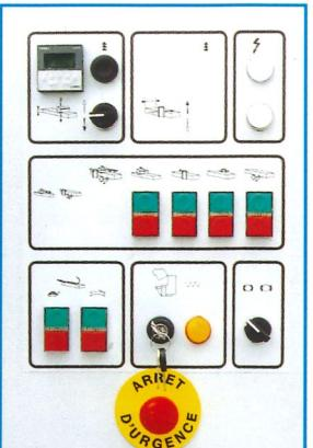
**P**upitre de commande. Montée-baisse de la poutre électrique avec réglage fin par impulsion et visualisation électronique.
