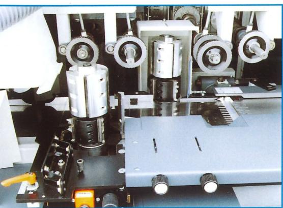
**T**oupies équipées d'un empilage d'outils à profiler de hauteur 90 mm et diamètre 180 maxi pouvant s'escamoter sous le plan de travail afin de calibrer avec l'outil standard diamètre 125 et hauteur 130 mm.
