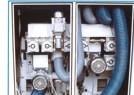
**L**a transmission de l'entraînement aux cinq rangées de galets est réalisée par ligne de renvoi d'angle et joints d'accouplement homocinétiques. The feeder is built of 5 reductionsystem and driveshaft to the rollers. Die Zuführwalzen sind durch Zahnräder getrieben.
