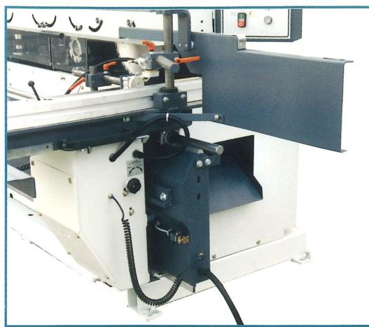
▶ Tenonneuse version TDE05 équipée d'une scie araseuse, dérouleur inférieur-supérieur + 2 toupies. Machine présentée avec option table motorisée, presseur pneumatique, motorisations verticales et horizontales des toupies avec afficheurs électroniques et boutons de commande sur pupitre.
