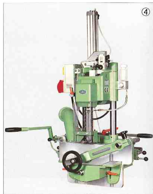
▲ KF 412 mit pneumatischem Kettenvorschub
