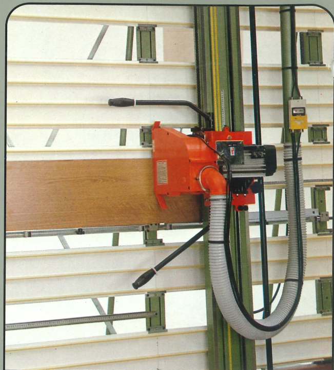
Sägevorgang von kleinen Platten auf der dafür vorgesehenen Auflage.
