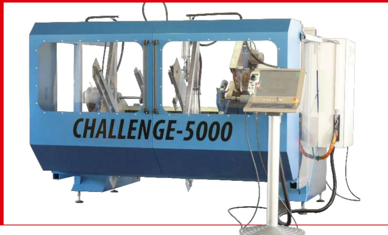
De la fabrication de grandes séries aux tâches les plus difficiles, le CHALLENGE-5000 offre une variété d'avantages techniques, la Tour à bois CNC est puissante et automatique, c'est une machine de haute précision de construction lourde en fonte grise et de fabrication allemande de première qualité. Le CHALLENGE-5000 est capable de tourner, fraiser, canneler, graver et rectifier.
