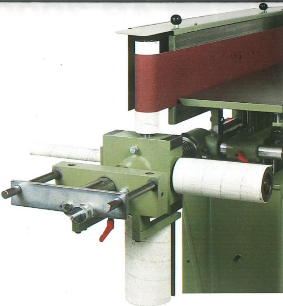
**HAPFO-Bandschleifmaschine für Rundungen und Kanten,**
