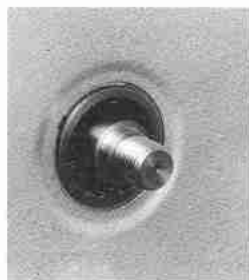
Ⓓ Aufsteckdorn MK 2 mit Gewindestiftsicherung für die Aufnahme von Backenfutter, Planscheibe usw.
