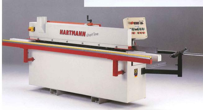
Maschine bis 5 mm Kantenstärke, Kettenbahn unten und zwei Reihen Druckrollen von oben, Schnellheizbecken, automatisch Ein-Aus, Rollenkappen bis 3 mm, Fräse für Ober- und Unterkante, Kombifräser R=3 und 5 mm gerade, Rollenteller D=700 mm, ausziehbare Rollenbahn vorne, Auflagen links und rechts 400 mm lang, Verkleidung mit eingebautem Zentralabsaugstutzen D=160 mm, Andruckeinheit mit 4 Druckrollen.
