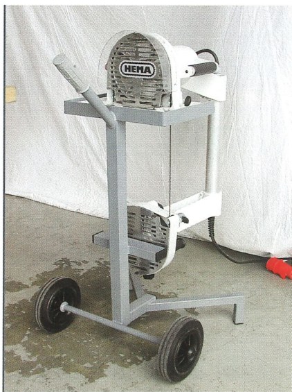
Transportwagen zum Absetzen und Aufbewahren der Maschine.
