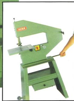
● Mit dem Einsatz schmaler Sägeblätter ist das Sägen enger und komplizierter Konturen möglich.
