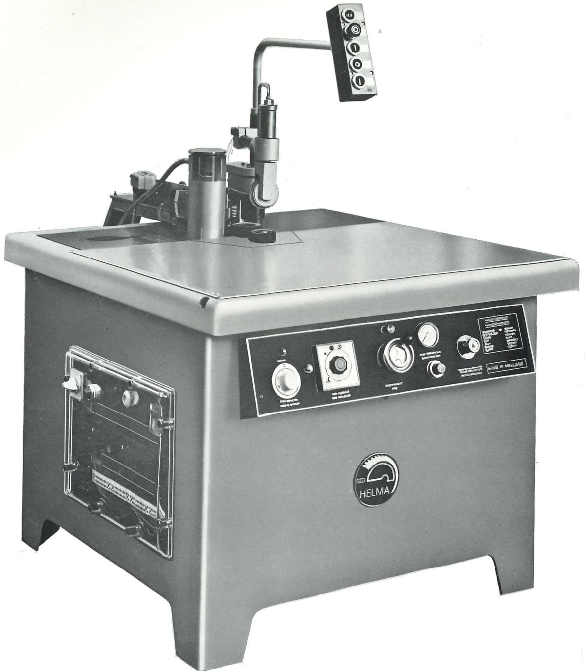
Die Verwendung von furnierten- und Kunststoff beschichteten Spanplatten hat in den letzten Jahren so stark zugenommen, dass eine **automatische** Kantenverleimung immer mehr an Bedeutung gewonnen hat. Noch vor kurzer Zeit gab es keine Lösung, Kanten so rationell bei **geschweiften** Werkstücken zu verleimen, um der heutigen Anforderungen gerecht zu werden.
