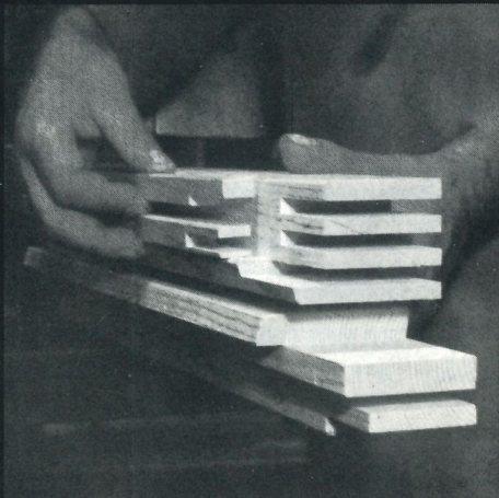
5) gemeinsames Innenprofilieren simultaneous internal profile cutting profilage intérieur simultané
