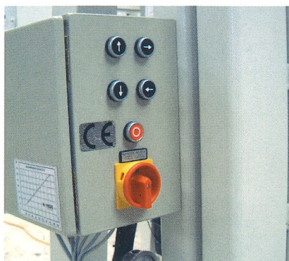
Steuerung über Tiptaster: „Pressen-Stop-Lösen“. Druckeinstellung mit Rändelschraube, Manometer und Presskraftdiagramm.
