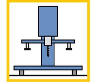
Die vielseitige Bohr- und Einpreßmaschine mit 8spindeligen Bohrkopf, davon 5 Spindeln für Lochreihenbohrungen.
