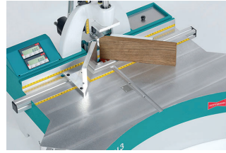
Innenanschlag mit Erhöhung
