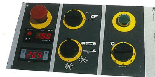
Quadro comandi con controllo elettronico della temperatura della colla nella vasca e controllo elettronico della temperatura di fusione della colla sul pannello.
