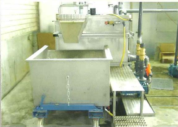
Wasserreinigungs- und Entschlammungsanlage PolyFloat 3000. / *Water treatment and paint sludge removal unit PolyFloat 3000.*
