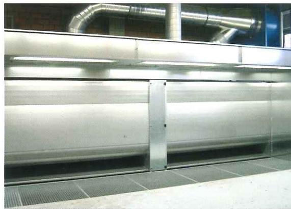
Gezielte Führung und Erfassung des Wassers in der wasserberieselten Farbnebelabsaugwand PWSL. / *Specific guiding and collection of water in the water wash paint wall PWSL.*
