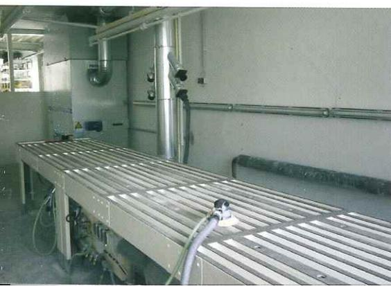
Die clevere Variante für den Anschluss an die zentrale Absauganlage oder an mobile Entstauber: der Schleifstaub-Absaugtisch Expert Z von HÖCKER POLYTECHNIK. / The smart version for the connection of a central exhaust plant or a mobile deduster: the sanding table Expert Z from HÖCKER POLYTECHNIK.
