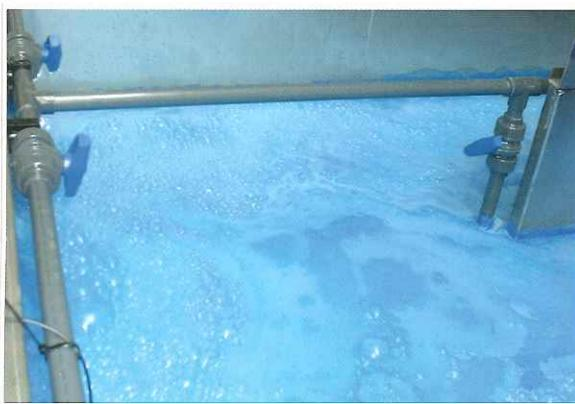
Lange Beruhigungs- und Aufschwimmzone für optimale Floatation der koagulierten Lackreste und klares Wasser. / *Long slow-down and floatation zone for optimal floatation of the coagulated paint residue and clear water.*
