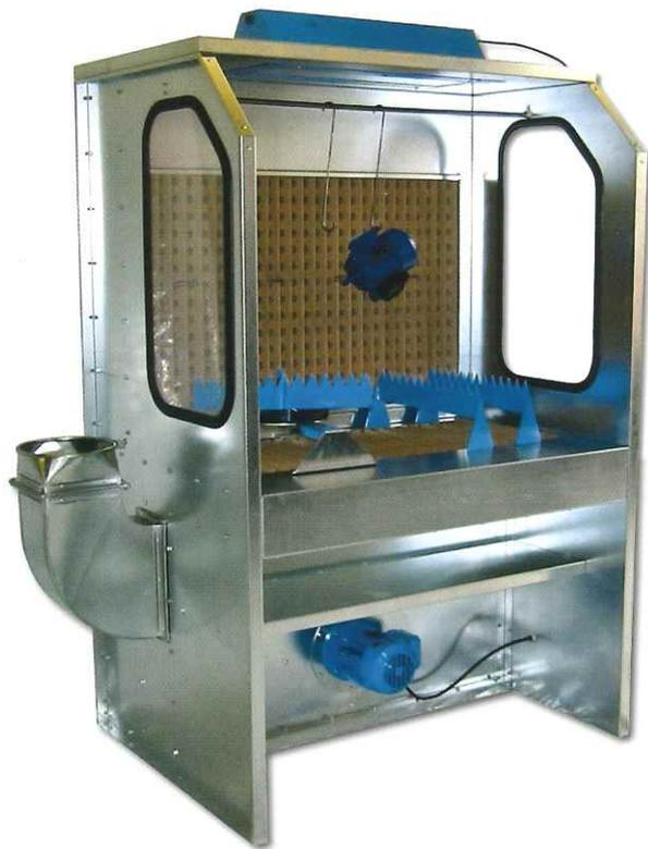
So einfach geht die Inbetriebnahme: Montierte Lackierbox auspacken, Abluftkanalbogen anschrauben (wahlweise rechts oder links), elektrischen Anschluss einstecken, fertig! /
