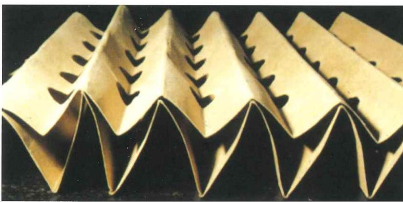
Mit den großzügig dimensionierten Öffnungen bleibt der Filterwiderstand auch bei hohem Sättigungsgrad erheblich geringer als bei üblichen Filtermatten. /
