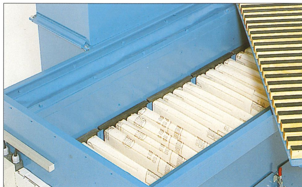
Die Filtertaschen befinden sich direkt unterhalb der Arbeitsfläche
