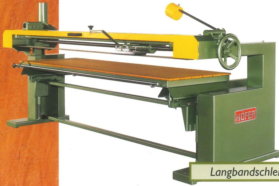
Langbandschleifmaschine BSM III
