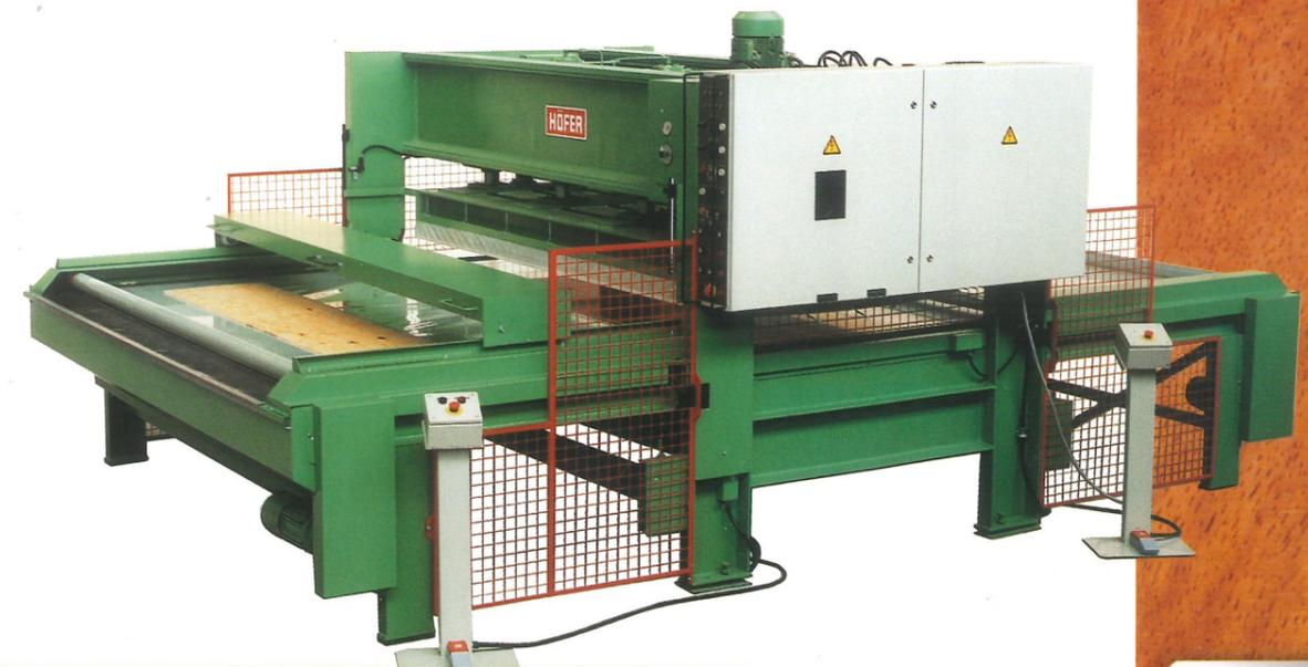
*Hydraulische Kurztaktdurchlaufpresse HKPL*
