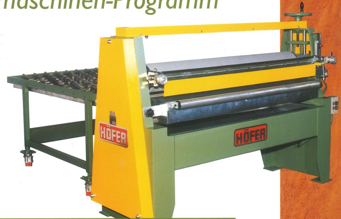
*Zwei-Walzen-Auftragsmaschine LAN 1300 Standard*
