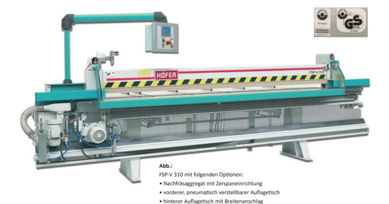
Die FSP-V ist die beliebteste Furniersäge unter den 3 Grundmodellen. Durch den elektromotorischen Vorschub ist diese Maschine besonders bedienerfreundlich und beugt vorzeitigen Ermüdungserscheinungen vor. Dadurch ist eine gleichbleibende Qualität der Furnierzuschnitte gegeben.
