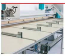
Hinterer Auflagetisch Die Breitenanschlagtiefe von 15 bis 600/900 mm wird per Handrad mit einer Genauigkeit von 0,1 mm verstellt. Die Maßreferenzierung erfolgt automatisch. (optional)
