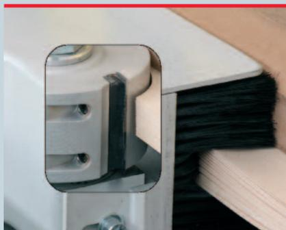
**Nachfräsaggregat mit Zerspaneinrichtung**
