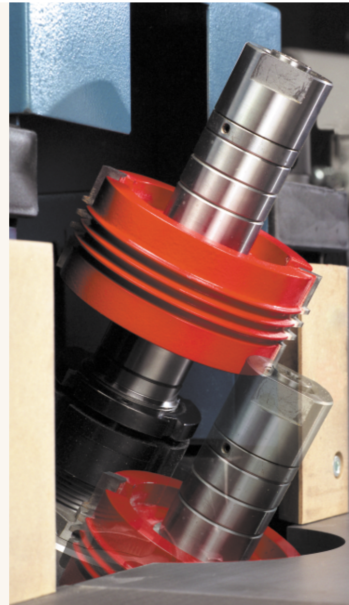
Höhenverstellung ohne Korrektur des Schwenkwinkels. Height adjustment without correcting the swivel angle. Réglage en hauteur sans correction de l'angle de pivotement.
