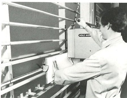
Ausklappbare Auflageleisten erleichtern das Sägen von schmalen Werkstücken
