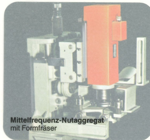
Mittelfrequenz-Nutaggregat horizontal (um 90° geschwenkt)
