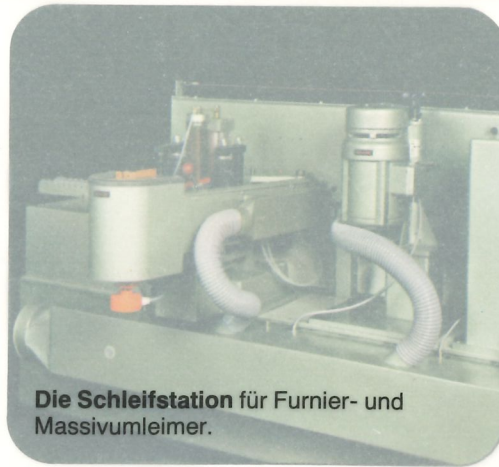
Das Kantenschleifaggregat zum Anfasen der aufgetragenen Umleimer
