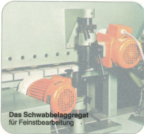
Die Schleifstation für Furnier- und Massivumleimer.
