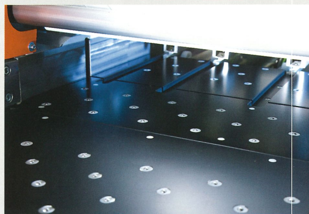
Coussins d'air dans la table de machine afin de protéger les décors de panneaux fragiles (Option).
