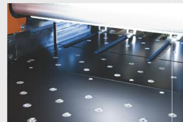
Colchón neumático en mesa de máquina para protección de la decoración delicada de los tableros.
